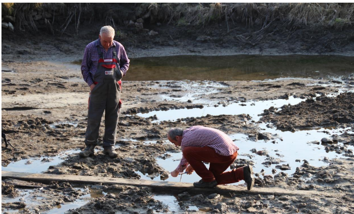
Pivovarský rybníček, Helmut Roith a Tomáš Kyncl při odběru dendrovzorků z dřevěné konstrukce umístěné ve dně rybníka (foto Z. Procházka 2015)
